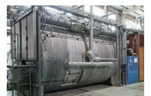
水分が瞬間的に水蒸気になる150度高温仕様様の乾燥機
